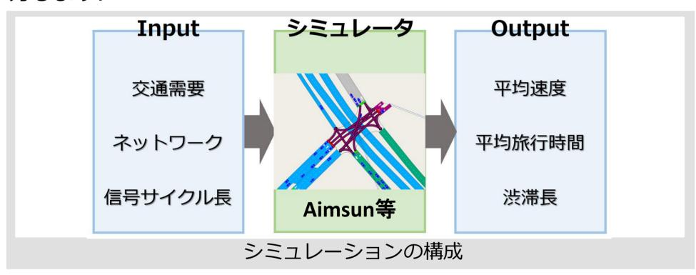
ミクロ交通流シミュレーションを用いた道路交通政策の効果予測を適切に評価するためには、現況再現性の高いOD表を入力データとする必要があります。しかし、現況再現性の高いOD表を得るには、シミュレーションの実行、真値と出力結果の比較、OD表のキャリブレーションといった作業を複数回繰り返す必要があります。上記の作業には、①大規模ネットワークかつ長期的なシミュレーションの場合、②真値として用いるデータのサンプル数が少ない場合において問題点があります。①では、データ量が膨大なためシミュレーションの実行に大きな計算負荷がかかります。例えば、起点と終点が70のネットワークで対象時間を10のスパンに分けてシミュレーションを行った場合、70×70×10=49000個もの入力データが必要となります。実際の都市は非常に複雑な道路網を有しているため、さらに多くのデータが必要となることが考えられます。②では、ドライバーの運転特性の偏りが顕著になるため、実際の交通状況とデータから推定される交通状況で
