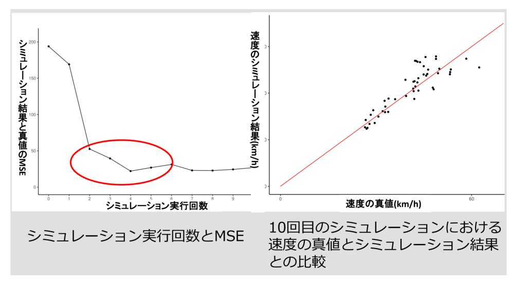
次に、既存のキャリブレーション手法であるSPSA algorithmsと本研究の提案手法の比較検証を行いました。提案手法の方がMSEの縮まり方が早い上に、キャリブレーションの計算時間がSPSA algorithms におけるそれの半分程度になっていることから、提案手法の有効性がわかります。しかし、これはエリアレベルに集約したキャリブレーションを考えているため、道路規模を詳細に考慮したキャリブレーション手法の確立が今後の課題となりました。
